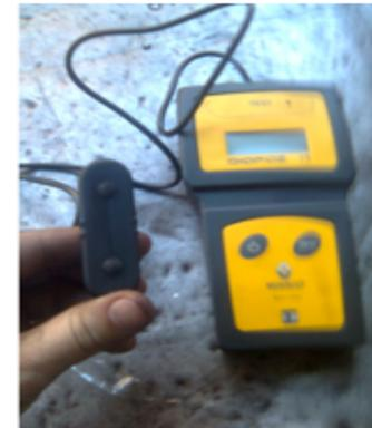
Che misura la tensione in base al rumore della cinghia quando la si fa schioccare, e abbiamo potuto rimontare e terminare così il lavoro.
